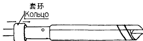
圖2 鑽筒合攏并加上套环 (Фиг. 2 Бур с блоком)
