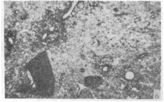
照片 6 黄夹泥, 湖南邵阳 致密微结构, 白色颗粒为粗粉砂和细砂, 黑色的为铁质 化矿物颗粒碎屑。左上右下为根际锈斑。单偏光 10×
