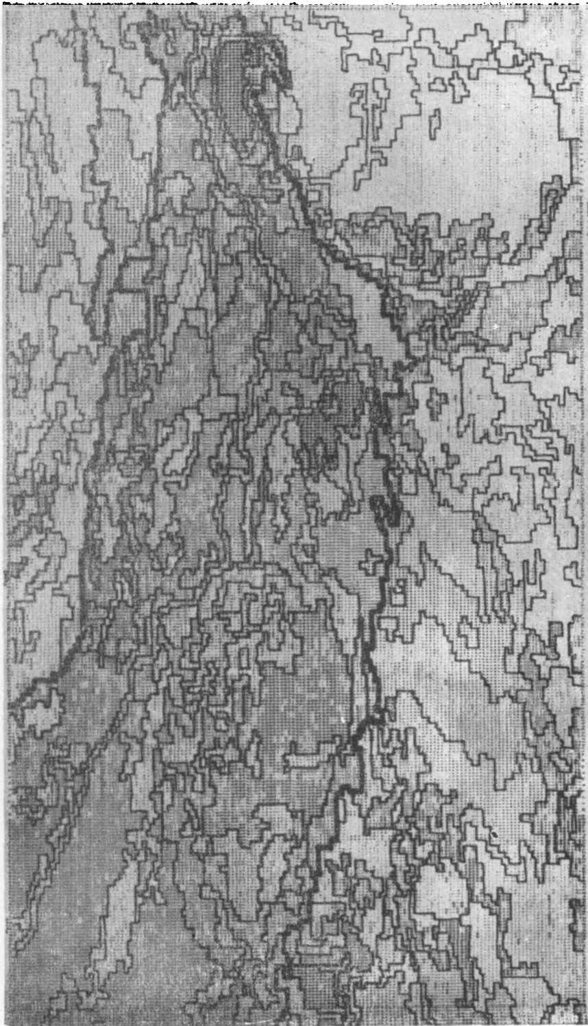
图版 IV 根据监督分类结果勾绘的地理控制线和土壤界线：右半部（注：比例尺同图版 III） ■ 地理控制区界线 土壤界线 —— 土壤界线
