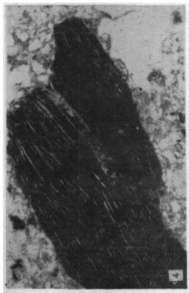
照片 4 普通棕壤(鲁 14) 14—28 厘米, 铁质化的 黑云母碎片(单偏光, ×72) Fig. 4 The fragment of ferric-mica, plain light, ×72, brown earth (S14), with a depth of 14—28 cm
