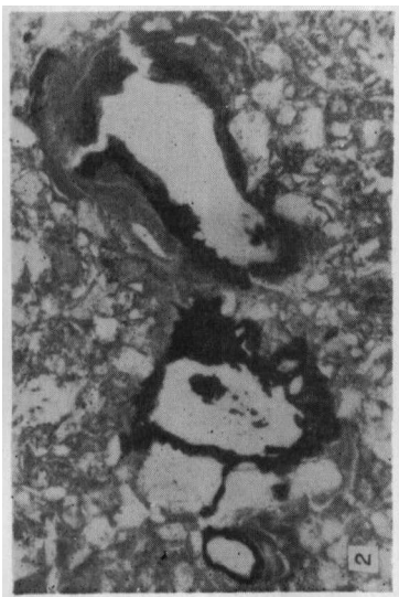
照片 2 普通棕壤(鲁 21), 17—40 厘米, 具同心圆 全结的铁质结核(单偏光, ×23) Fig. 2 Ferric-concretion, plain light, ×23, brown earth (S21), with a depth of 17—40 cm
