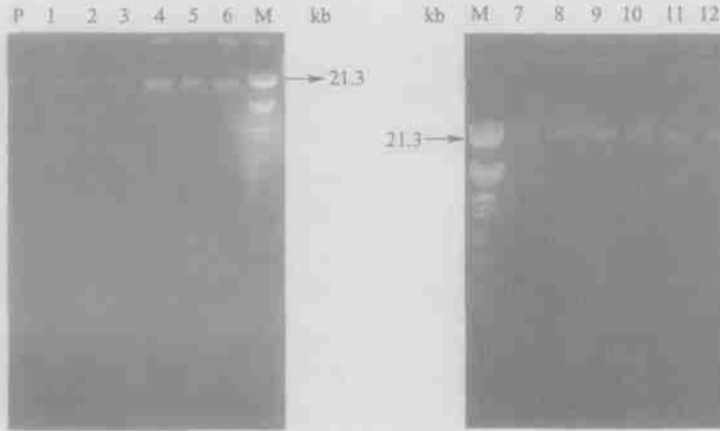
图2 水稻土细菌总 DNA 二次纯化的琼脂糖电泳(M: 分子量标准; P: 0 d 土壤细菌总 DNA; 1、4、7 和 10 分别代表 A4 在 5、25、45 和 70 d 取样时的细菌总 DNA; 2、5、8 和 11 分别代表 A5 在 5、25、45 和 70 d 取样时的细菌总 DNA; 3、6、9 和 12 分别代表 A6 在 5、25、45 和 70 d 取样时的细菌总 DNA)
