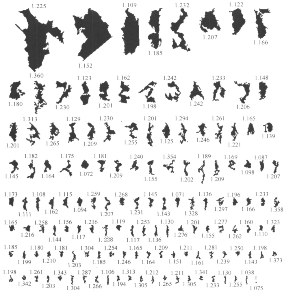
图 7 SL-5 土样的孔隙轮廓图像及其表面分维数
