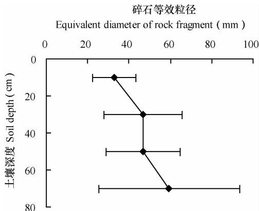
图 7 碎石等效粒径沿土壤剖面的变化
