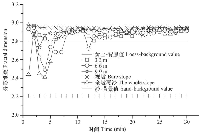
图4 不同覆沙厚度下分形维数的变化 (全坡覆沙、雨强 $1.5 \text{ mm min}^{-1}$ )
