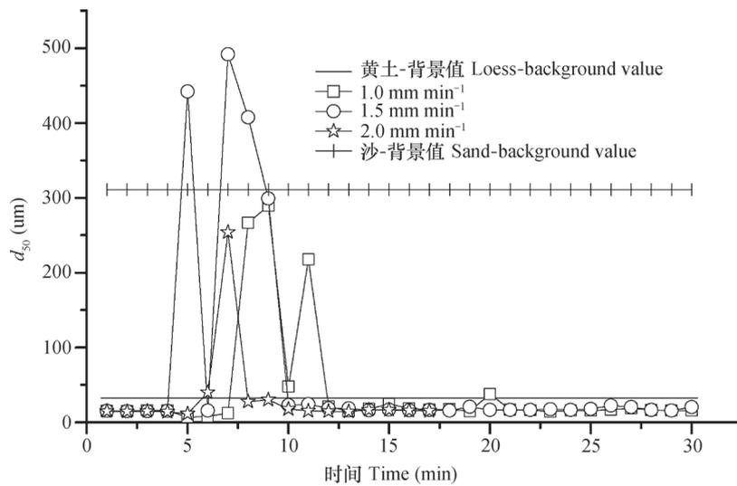
图5 不同雨强下 $d_{50}$ 的变化 (全坡覆沙、覆沙厚度1.0 cm)
