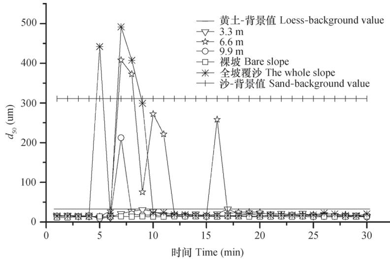
图7 不同覆沙长度下 $d_{50}$ 的变化 (雨强 $1.5 \text{ mm min}^{-1}$ 、覆沙厚度 $1.0 \text{ cm}$ )
