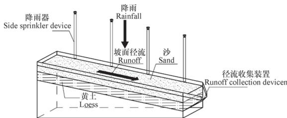
图1 模拟降雨试验装置图
