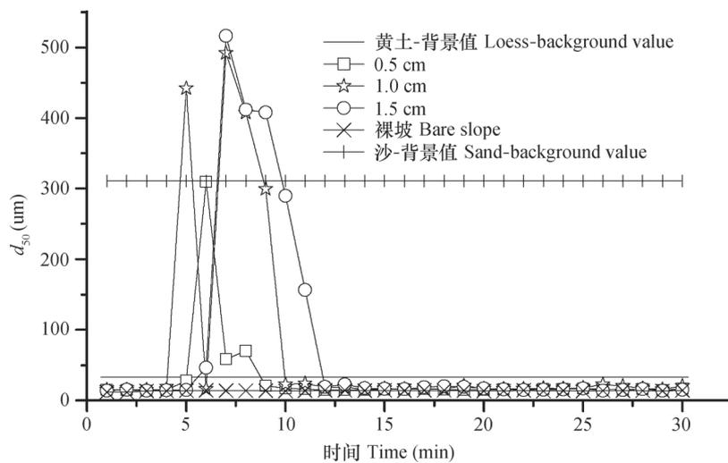
图6 不同覆沙厚度下 $d_{50}$ 的变化 (全坡覆沙、雨强 $1.5 \text{ mm min}^{-1}$ )
