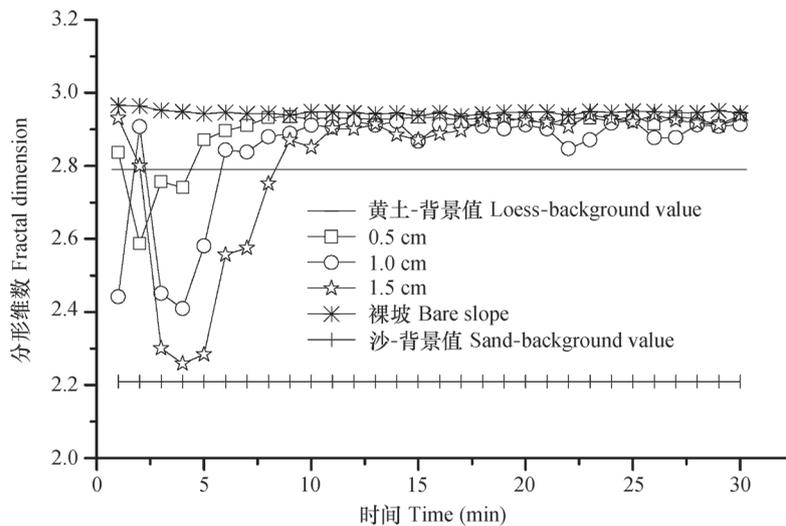
图3 不同覆沙厚度下分形维数的变化 (全坡覆沙、雨强1.5 mm min<sup>-1</sup>)
