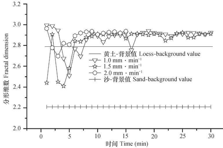
图2 不同雨强下分形维数的变化 (全坡覆沙、覆沙厚度1.0 cm)
