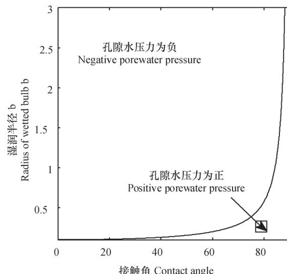
图6 黏土颗粒间 $u_a - u_w = 0$ 时的函数曲线
