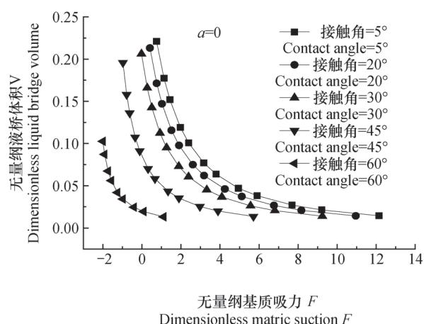
图3 球体颗粒间无量纲基质吸力与液桥体积关系
