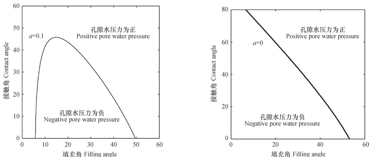
图4 球体颗粒间 $u_a - u_w = 0$ 时的函数曲线
