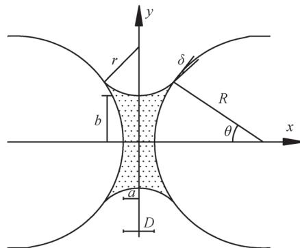
注：R：土颗粒半径；δ：接触角；D：砂土颗粒间距；b：液面底端高度；r：弯液面半径；a=D/2；θ：填充角，下同
