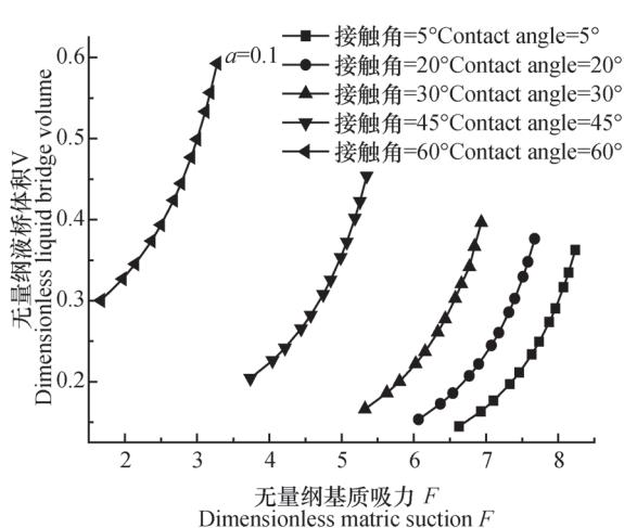
图5 黏土颗粒间无量纲基质吸力与液桥体积关系曲线
