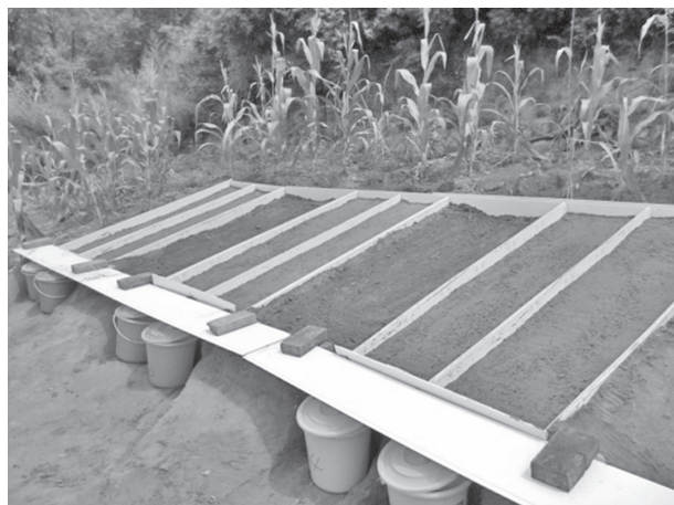
图1 野外原位观测试验的微型径流小区
