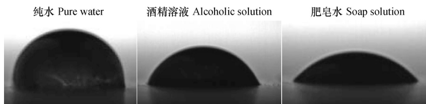
图4 基底表面三种液滴的几何形态
