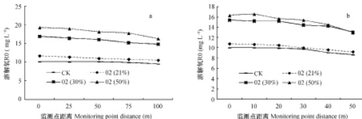
图1 不同氧浓度条件下供水管道 (a) 与滴灌带 (b) 不同监测点距离溶解氧浓度变化
