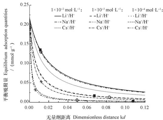
注：■、○和+分别表示不同浓度下 $\text{Li}^+$ 、 $\text{Na}^+$ 和 $\text{Cs}^+$ 实际达到距离表面的位置； $kd$ 表示无量纲距离 Note: ■、○ and + stands for actual location of  $\text{Li}^+$ ,  $\text{Na}^+$  and  $\text{Cs}^+$  from the surface, respectively, relative to concentration; and  $kd$  for dimensionless distance
