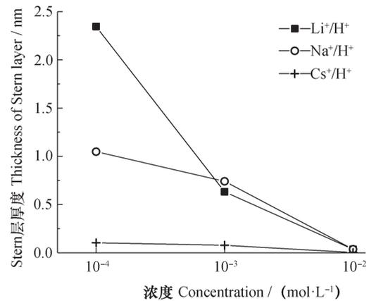
图4 不同浓度的Li<sup>+</sup>、Na<sup>+</sup>和Cs<sup>+</sup>电解质溶液中Stern层的厚度
