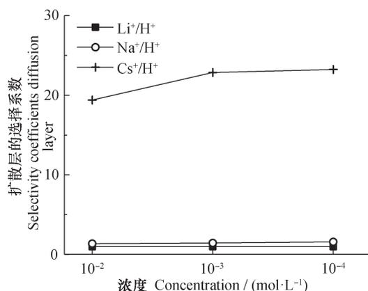
图6 不同浓度  $Li^+$ 、 $Na^+$  和  $Cs^+$  电解质溶液中扩散层的选择系数  $K_{i/H}^{diff}$
