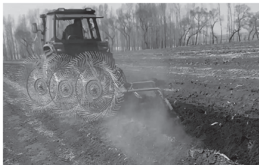
图3 第二代秸秆深还机具——“三合一”一体机
