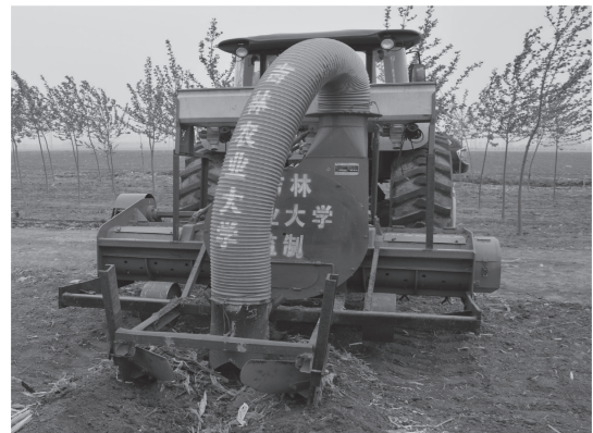
图4 第三代秸秆深还机具——风力注入筒式犁
