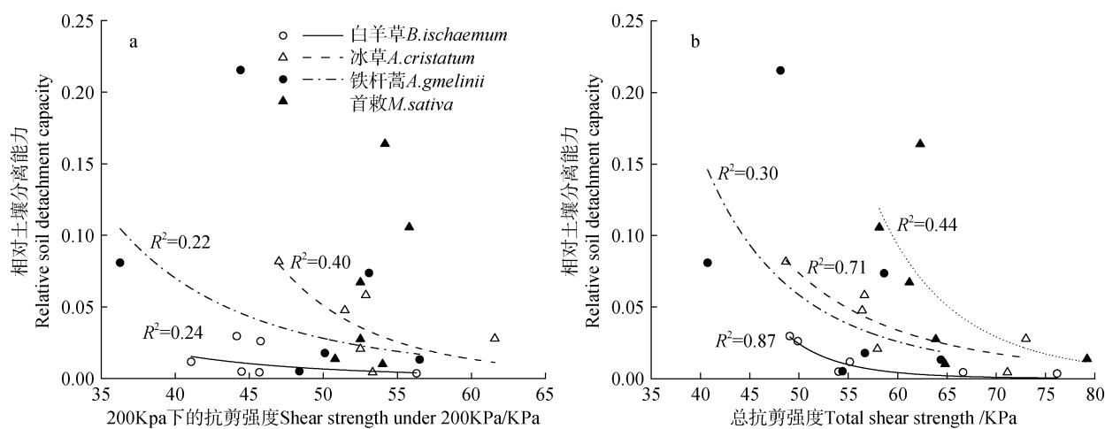
图6 相对土壤分离能力与抗剪强度的关系
