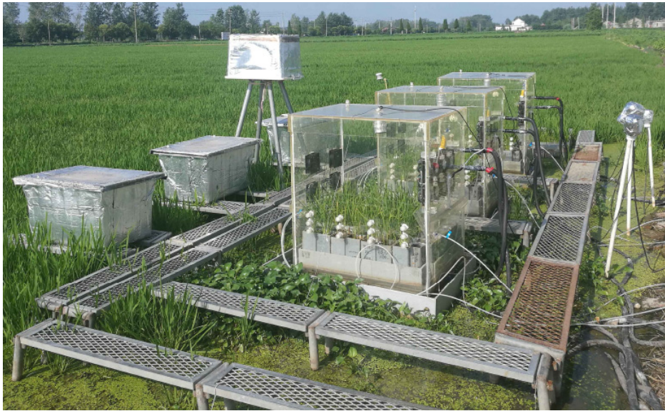
图 2 田间原位气密植物生长控制系统 Fig. 2 In-situ field air-proof plant growth system
