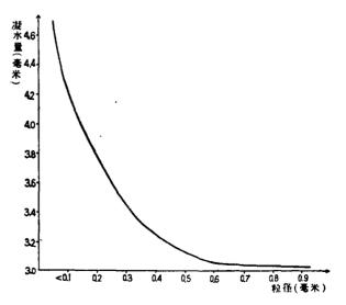
图 6 凝水量与沙粒径的关系
