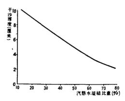
图 2 沙中汽态极水量比重与干沙厚度的关系
