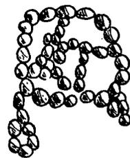
圖 3 烏泥田團聚體磨片觀察的一部分——環狀粒組排列示意圖
