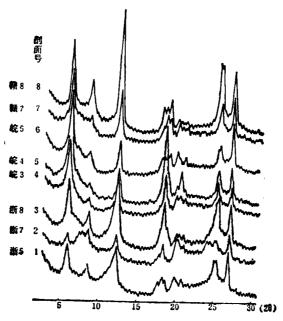
图 1 粘粒(<1µ)的 X 射线衍射图谱(镁-甘油饱和薄片)
