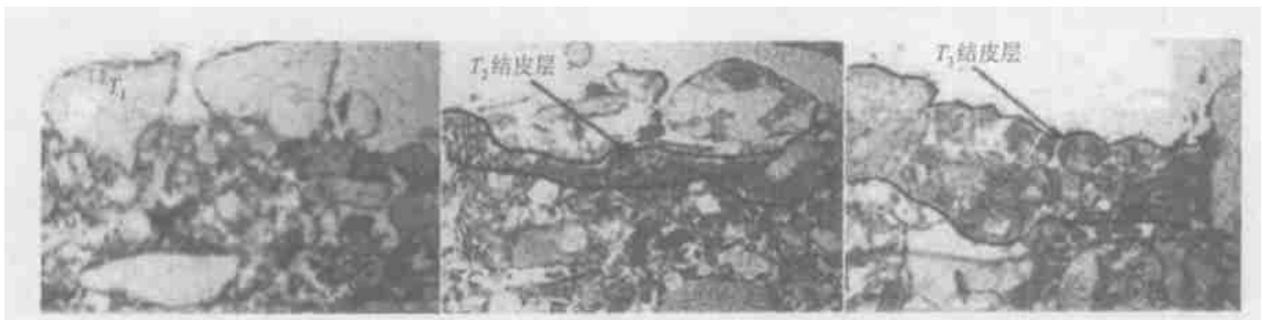
图 2 降雨历时 T_1=5 \text{ min} , T_2=10 \text{ min} , T_3=15 \text{ min} 湖北罗田黄棕壤结皮发育过程(单偏光, 4\times 3.3 )
