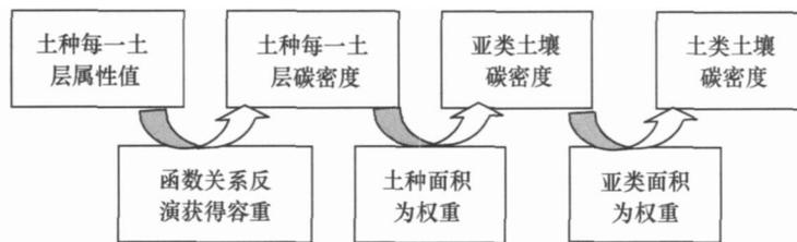
图 2 土壤有机碳密度计算流程图
