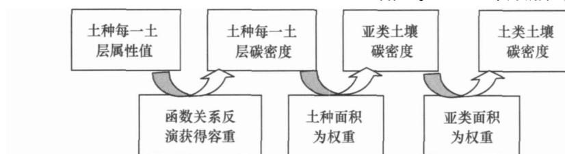
图 2 土壤有机碳密度计算流程图
