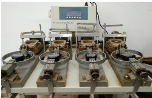
图 2 ZJ 型应变控制式直剪仪
