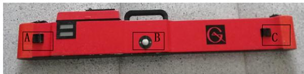
图 2 EM38-MK2 大地电导率仪构造
