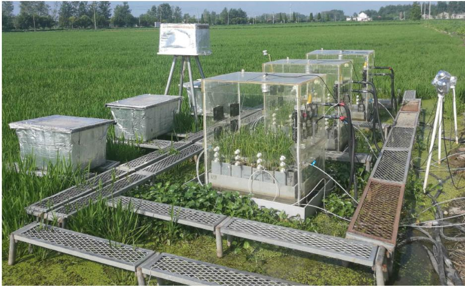
图 2 田间原位气密植物生长控制系统
