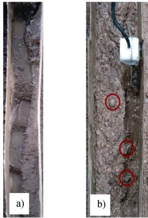
图 8 细沟侵蚀阶段中出现的现象: a) 跌坎; b) 碎屑
