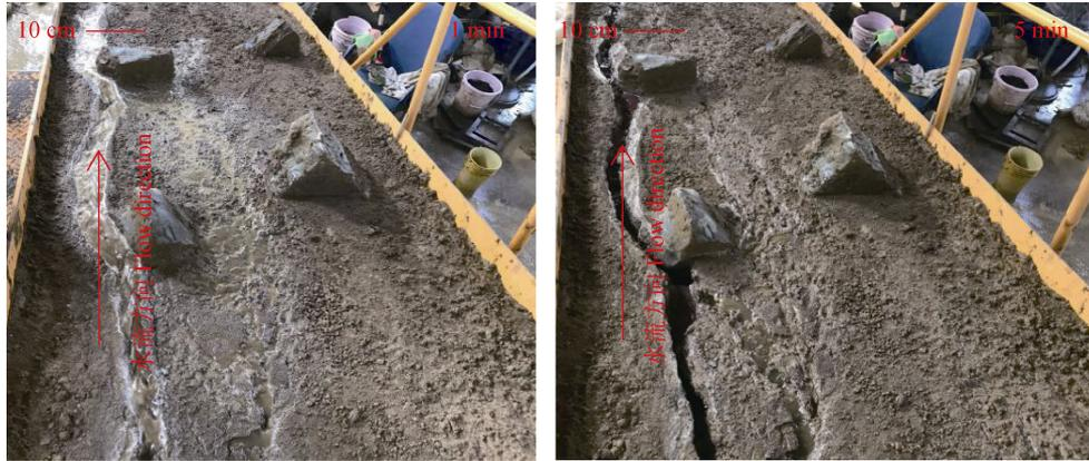
图3 模拟试验坡面侵蚀细沟局部
